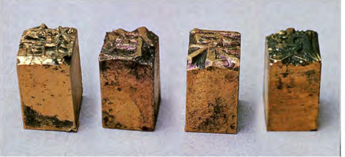
Görsel 6. Hareketli harf baskısı için üretilmiş bakır harf kalıpları.
